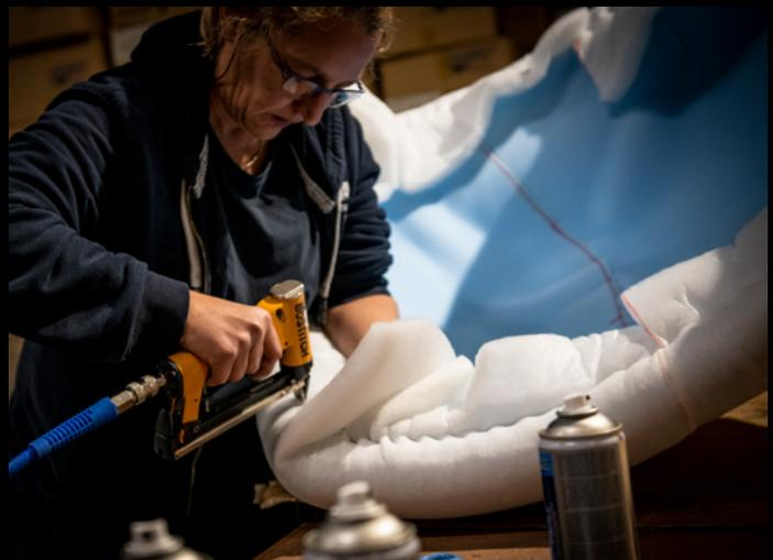
▲ Sur la coque en fibre de verre, l'opératrice colle la mousse au pistolet.
